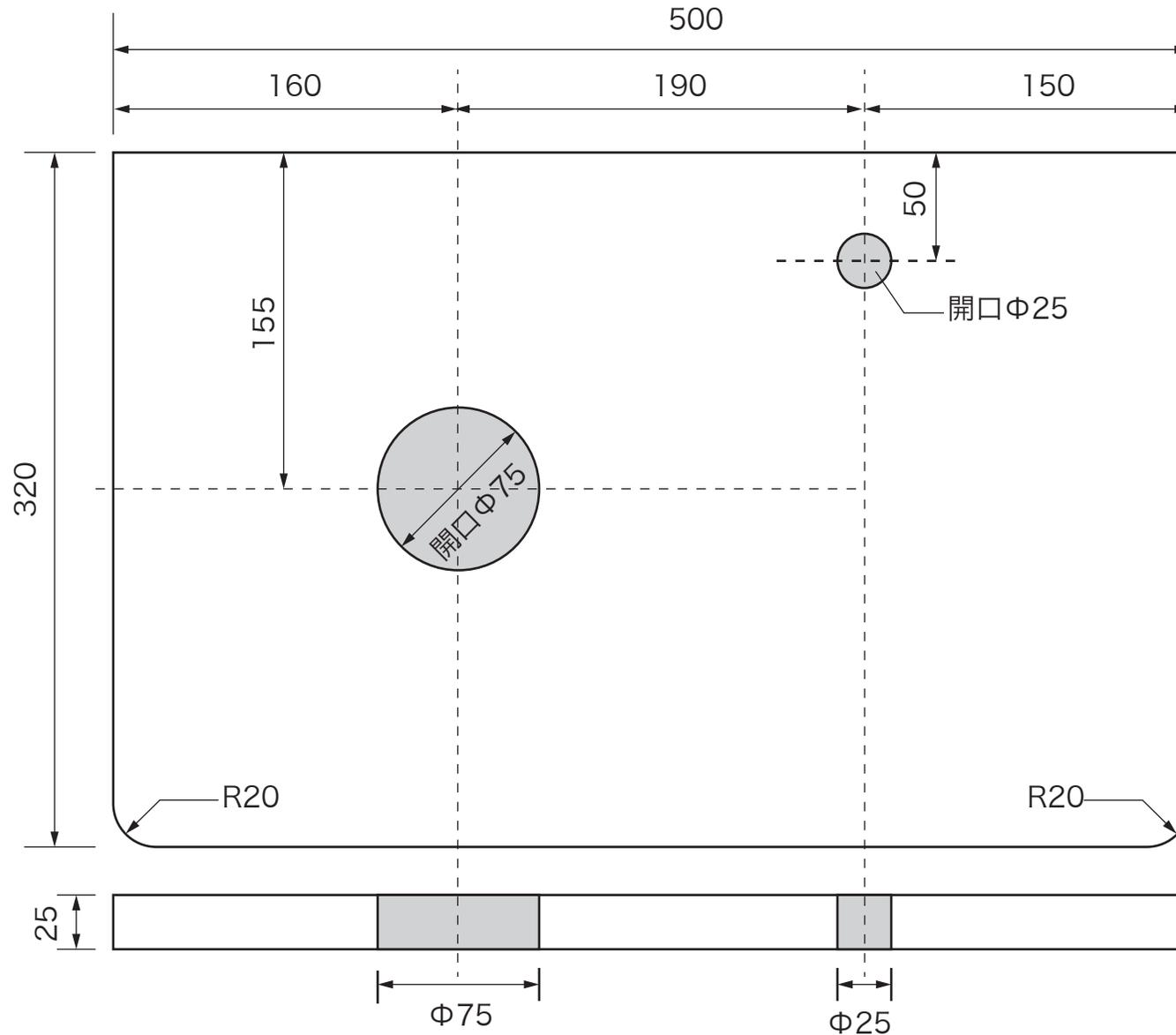
※排水穴 $\phi 75$ mmと水栓取付穴 $\phi 25$ mmが開口されています。
